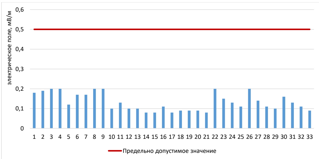
Рис. 3. Электрическое поле (кВ/м) на расстоянии 15 см.
