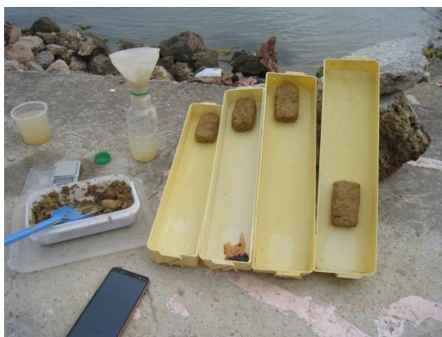
Рисунок 6. Моделирование оползневых процессов
