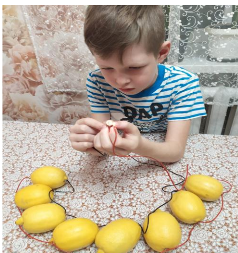
Рисунок 3. Рабочая модель батарейки из лимона.
