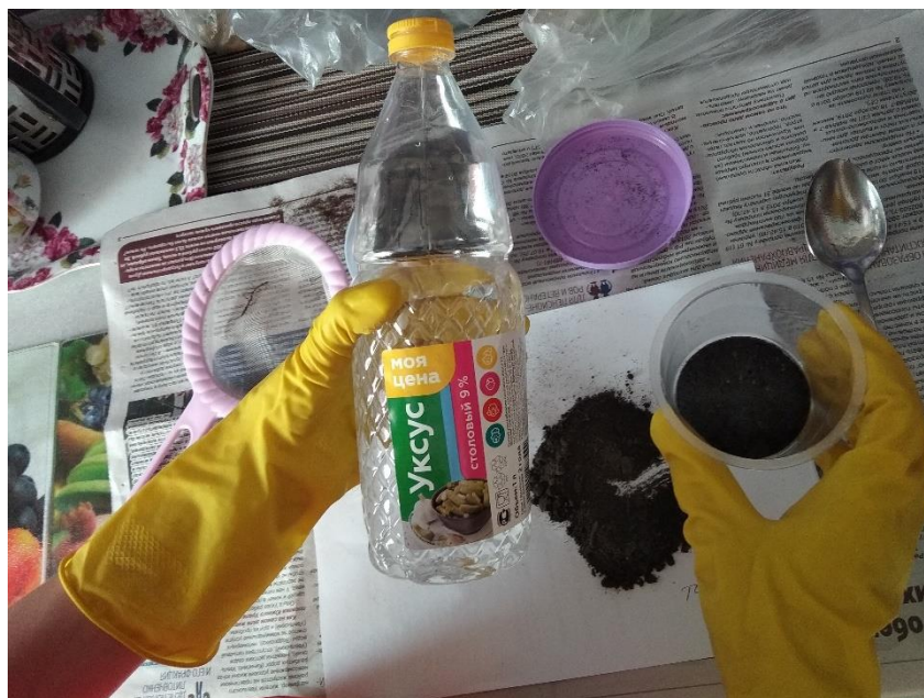
Рисунок 2. Определение кислотности почвы с помощью уксуса 9%
