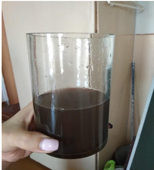
Рисунок 4. Раствор с пробой почвы для измерений датчиком рН
