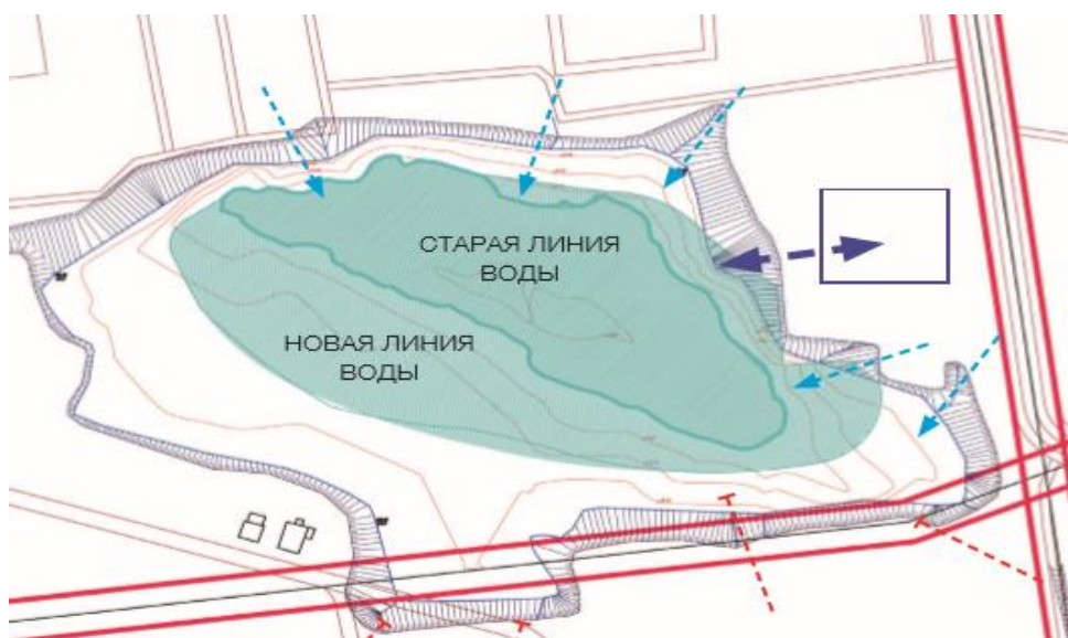
Рисунок 1 – Сток поверхностных вод с рельефа местности
