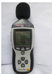
Рис.1. Шумомер SL-300 (использовался в работе) – фото автора
