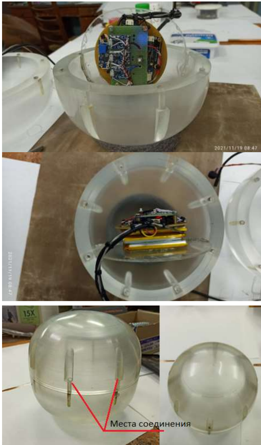
Рис. 9 Корпус и сборка автономного буя
