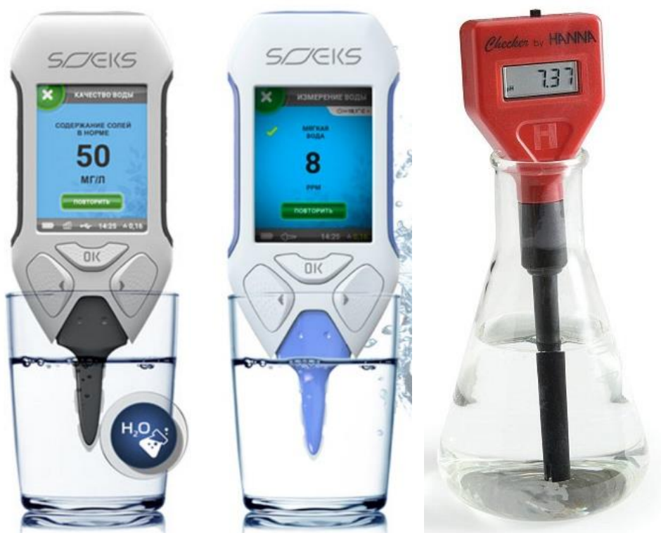
Рисунок 1 – Приборы, используемые при проведении измерений слева направо: Эковизор «Соэкс» F3 [2], Эковизор «Соэкс» F4 [4], рН-метр «Hanna»
