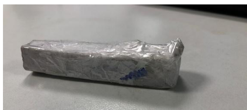
Магнитная сборка Халбаха из неодимовых магнитов
